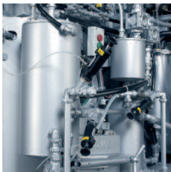
Verhindert Geruchsbildung: das Wasserabscheidesystem
