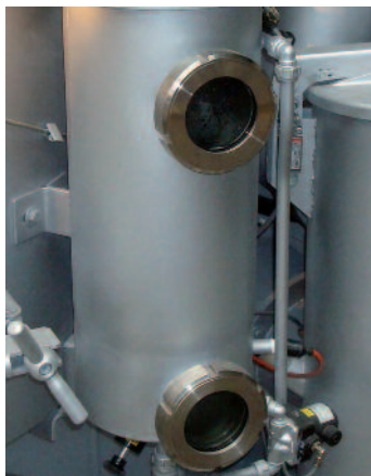
Wartungsfrei: der selbstreinigende Wasserabscheider mit integriertem Nachwasserabscheider
